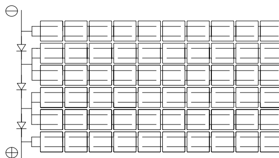
Abbildung 7: Schaltungsanordnung von Zellen und Bypassdioden
